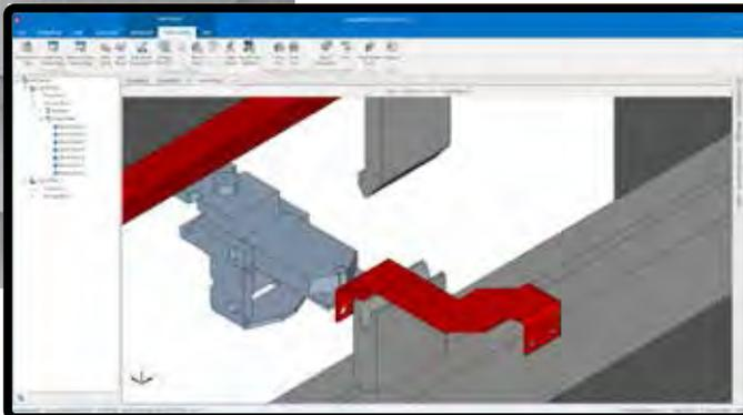
SigmaBEND proporciona una solución de programación automática para reducir el cuello de botella en el plegado a través de una mayor precisión, la optimización de la configuración y los utillajes, y la programación estandarizada de la secuencia de plegado.
